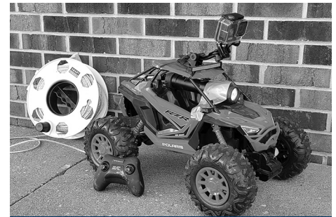
Des Moines County’s culvert inspector device
